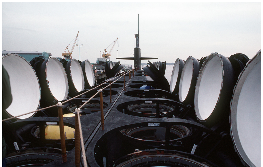
Deckansicht des U-Boots Ohio der US-Marine mit geöffneten Silos für ballistische Raketen des Typs Trident C-4. Flickr / National Museum of the US Navy
