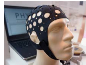
Illustration 7 Meegaperf, casque EEG (pour électroencéphalographie) de la société Physip qui mesure l'activité cérébrale de son porteur et en déduit son état de stress et de fatigue. (http://hightech.bfmtv.com/produit/l-equipement-high-tech-au-service-du-soldat-du-futur-984618.html)
